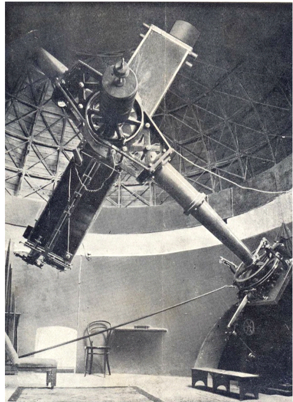
Figure 3. The Catania Observatory Steinheil Astrograph used for the Carte du Ciel and Astrographic Catalog in a photo dating to 1894. Credits R. Osservatorio Astrofisico di Catania all'Esposizione Universale di Roma A. XX; Tav. V
